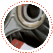
Nadellager in beiden Schubstangenäugen
